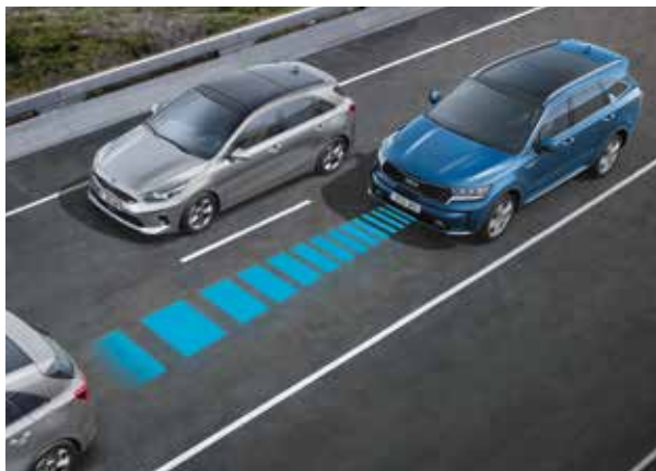
Asistente de mantenimiento en carril (LKA). A tu lado para mantenerte concentrado: Una cámara en la parte delantera del coche controla las marcas del carril y, si el conductor se sale del carril sin querer, la LKA te alerta e incluso te lleva al carril de vuelta.
