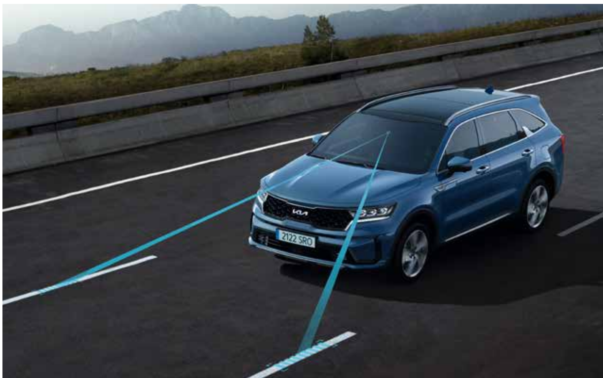
Asistente de mantenimiento en carril (LKA). A tu lado para mantenerte concentrado: Una cámara en la parte delantera del coche controla las marcas del carril y, si el conductor se sale del carril sin querer, la LKA te alerta e incluso te lleva al carril de vuelta.
